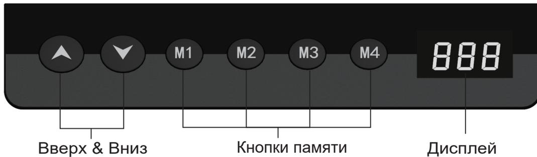
Передняя панель пульта полностью сенсорная. Если пульт не используется в течении 30 секунд, экран и кнопки памяти блокируются. Для разблокировки используйте кнопки Вверх или Вниз. Когда дисплей подсвечен, пульт полностью разблокирован и готов к работе.
