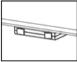
Одну из кнопок переведите в положение вкл. (I), а второй управляйте подъемом стала
